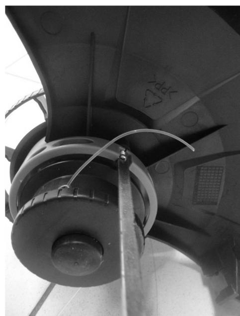
**Installation ou suppression de la tête à fils de nylon - Installeren of verwijderen van de kop zoon nylon - Installing or removing the head son nylon**
