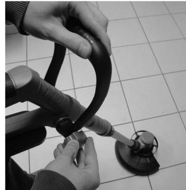
**Installation du protège-lame - De beschermkap installeren - Installing the blade guard**
