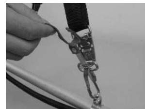
Pour parer à toute éventualité, à l'utilisation d'un harnais : s'entraîner pour savoir se dégager rapidement de la machine. Lors de cet exercice, ne pas jeter la machine sur le sol, pour ne pas risquer de l'endommager.
