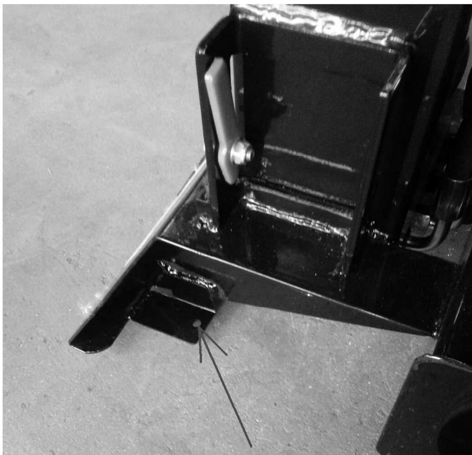
**FR** Pour éviter le renversement, la machine doit être fixée au sol !
