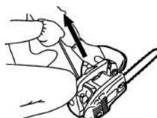
Coloque el cuerpo de la máquina en tierra firme y asegúrese de que no hay obstáculos alrededor. Entonces, mientras sostiene la manija delantera con la mano izquierda y poner el pie derecho en el marco, tire lentamente del cordón de arranque.
