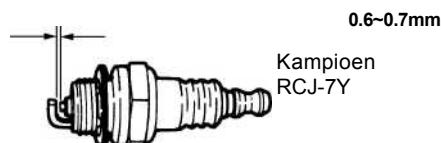
Reinig de elektroden met een staalborstel en het terugstellen van de kloof tot 0,6 mm als nodig is.
