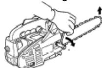
8. Draai de spanner schroef.
