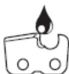
Durante la operación, deberá haber suficiente aceite de cadena en el depósito de aceite de cadena para obtener buena lubricación de la cadena. Un llenado será suficiente para una hora y media aproximadamente de operación continua. Cuando esté trabajando, compruebe que aún hay suficiente aceite de cadena en el depósito y rellene si es necesario. **¡Compruebe solamente cuando el motor esté apagado!**
