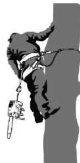
Lorsque vous changez le point de fixation de la tronçonneuse, assurez-vous qu'elle est correctement fixée dans sa nouvelle position avant de la défaire de la première.
