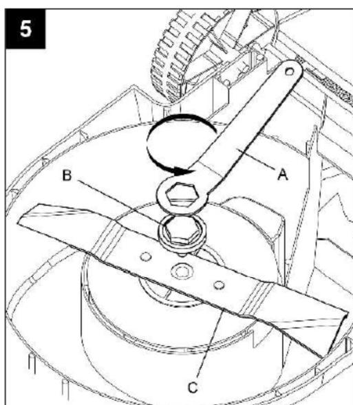
La clé pour desserrer la lame de la tondeuse **n'est pas fournie** avec la tondeuse LTDE1332-20
