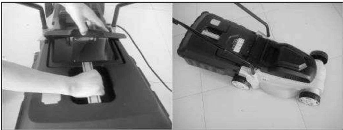
**B RACCORDEZ LA MACHINE A L'ALIMENTATION ELECTRIQUE / AANSLUITING OP HET NET
