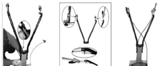
Coloque y alinee el brazo del asa sobre la base y fíjelo con 4 pernos.
