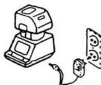
La charge démarre avec le branchement du chargeur dans la prise de courant et en plaçant l'accu dans son
