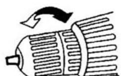
En caso de un ajuste correcto, se abre un acoplamiento de carraca tan pronto se ha enroscado a ras en el material el tornillo. En el caso del desenroscado, seleccionar un ajuste superior resp. situar el selector en el símbolo de broca. El ajuste correcto se debe averiguar mediante ensayos prácticos.
