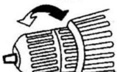
Se la regolazione è corretta si apre un innesto di scatto non appena la vite è avvitata a filo nel materiale. Per lo svitamento selezionare una regolazione più elevata o commutare sul simbolo di trapano. La regolazione corretta va determinata per tentativi.
