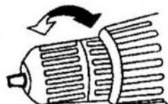
Bei richtiger Einstellung öffnet eine Überraschkupplung, sobald die Schraube bündig in das Material eingedreht ist. Beim Herausdrehen höhere Einstellung wählen, bzw. auf Bohrsymbol stellen. Die optimale Einstellung ist durch den praktischen Versuch zu ermitteln.
