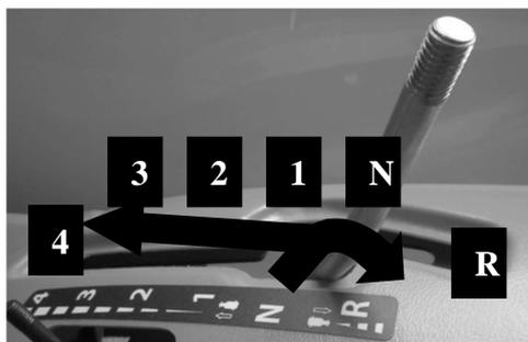
Ce levier a six positions pour les quatre vitesses avant, le point mort « N » et la marche arrière « R ».
