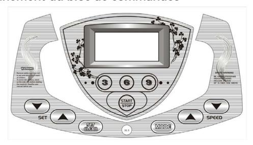
Alimentez le tapis roulant en le branchant dans la prise murale appropriée ; allumez ensuite à l'aide du bouton situé sur l'avant du tapis roulant sous le couvercle du moteur. Vérifiez que la clé de sûreté est bien en place, car le tapis roulant ne s'allumera sans elle.
