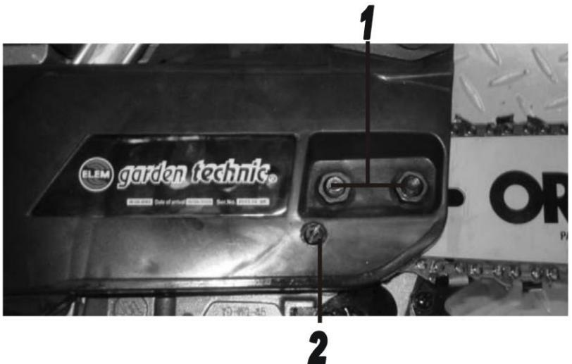
De spanning van de ketting dient gecontroleerd te worden **voor** ieder gebruik, alsook bij gebruik, na iedere 10 minuten.
