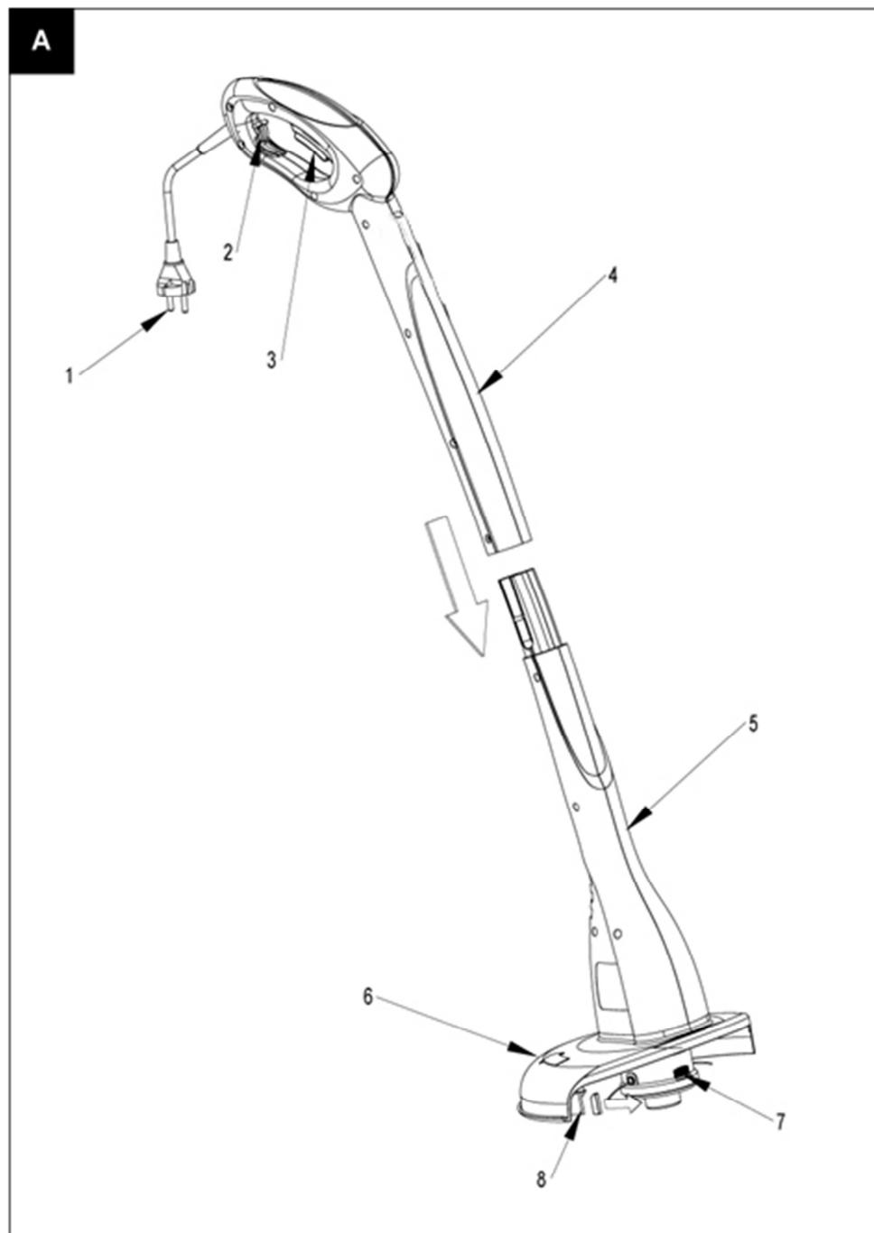
**Montage du carter de protection - Monteren van de beschermkap - Mounting the guard**
