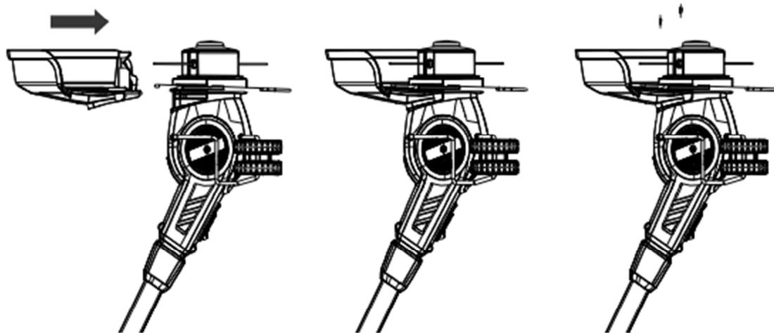
**AVERTISSEMENT !** N'utilisez jamais l'outil sans protection de sécurité. L'utilisation de l'outil sans protection de sécurité entraîne une surchauffe du moteur et annule la garantie.
