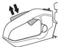
Contrôlez que la gâchette du papillon des gaz et le verrouillage de la commande du papillon des gaz sont libres de mouvement et que le ressort de rappel fonctionne correctement.
