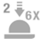
Appuyez de manière répétée sur le diaphragme de purge d'air jusqu'à ce que le carburant commence à remplir le diaphragme (environ 6 fois). Le diaphragme ne doit pas être complètement rempli.
