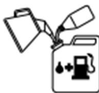
L'indice d'octane le plus recommandé est 90 (RON). Si vous faites fonctionner le moteur avec une essence d'indice d'octane inférieur à 90, il peut se produire du cliquetis. Ceci donne lieu à une température élevée du moteur, qui peut entraîner de graves dommages du moteur.
