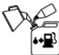
Het aanbevolen laagste octaangetal is 90 (RON). Laat u de machine draaien op een lager octaangetal dan 90 kan het zogenaamde kloppen van de motor optreden. Hierdoor ontstaat een hoge motortemperatuur, wat kan resulteren in ernstige motorschade.
