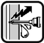
**Attention aux conduites électriques, aux tuyaux et conduites dissimulées de gaz et d'eau. Contrôler la zone de travail, avec un détecteur de métal par exemple.**
