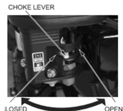
Laissez le levier étrangleur sur la position OPEN/OUVERT pour le redémarrage d'un moteur chaud.
