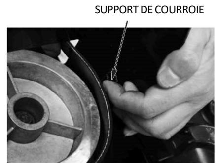
12. Remettez en place le moteur, placez les courroies sur leur propre trajectoire.
