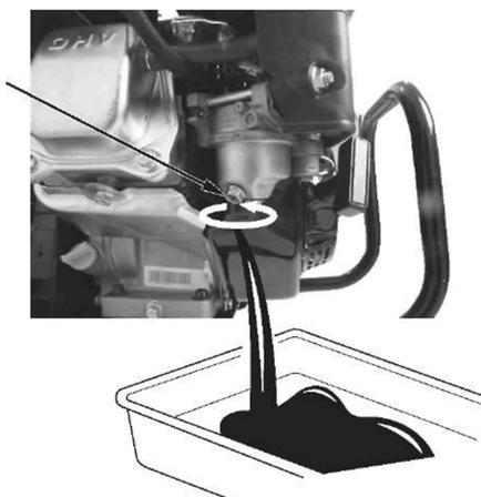
3. Après l'écoulement du carburant dans le récipient, bien serrer la vis de drainage.
