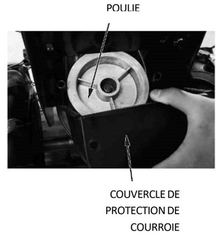
11. Poussez légèrement le support de courroie et retirez la courroie devant être changée. Installez les nouvelles courroies de la même manière que les courroies d'origine. Remettez en place le couvercle de protection de courroie.
