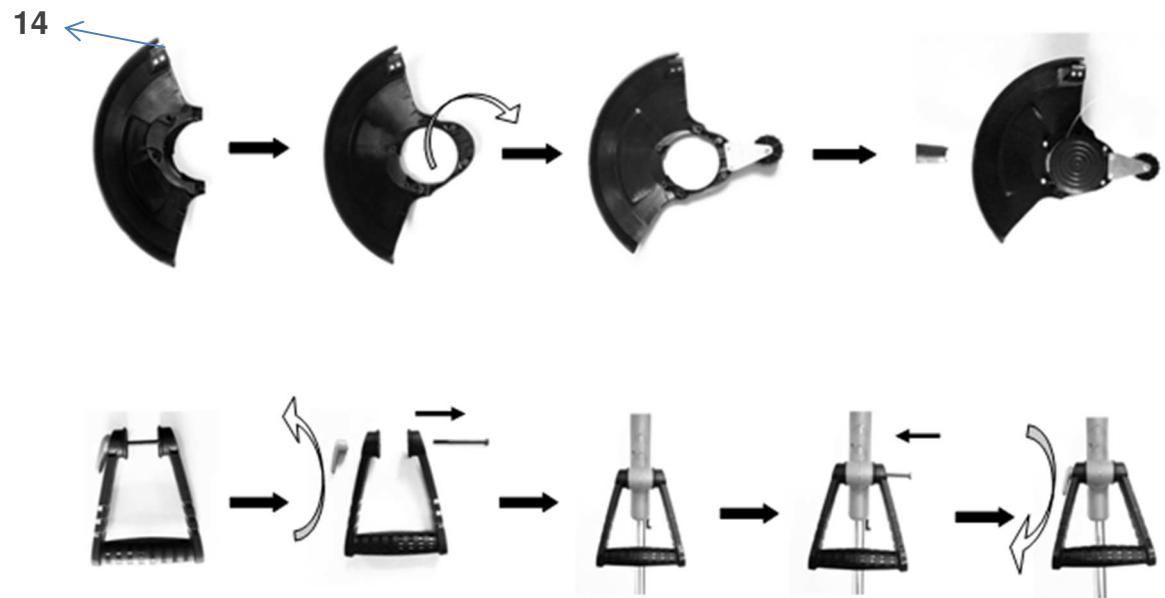
**Réglage en hauteur - Hoogte aanpassing - Height adjustment - Telescopico**
