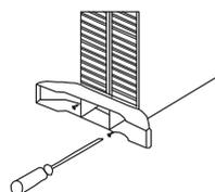
Avant d'utiliser le radiateur, les pieds (fourni séparément dans le carton), doivent être montés sur l'appareil. Ceux-ci doivent être fixés à la base de l'appareil à l'aide des 4 vis auto-taraudeuses fournies, en prenant soin de
