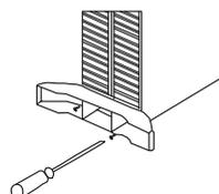
Alvorens het toestel, moet voet (in de doos apart geleverd) op het apparaat worden geïnstalleerd. Deze moeten aan de voet van het apparaat met de vier zelftappende schroeven, en zorg
